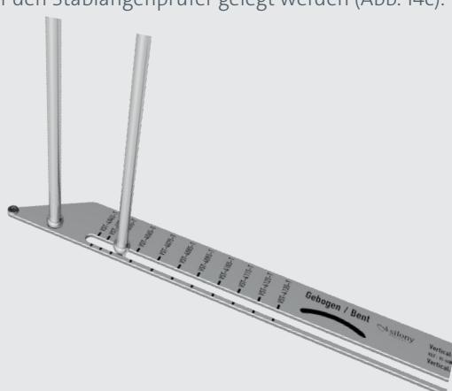
Abb. 14b Ablesen der Stablänge an dem Stablängenprüfer
