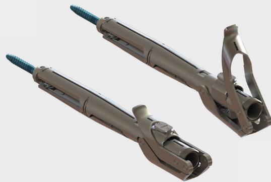
Abb. 2 Temporäre Fixierung der Polyaxialität mit dem VERTICALE ML Verblockungs- und Repoturm und dem VERTICALE ML Turm Quick Release Einsatz; oben) Polyaxialität frei beweglich; unten) Polyaxialität blockiert sobald der proximale Hebel umgelegt ist.
