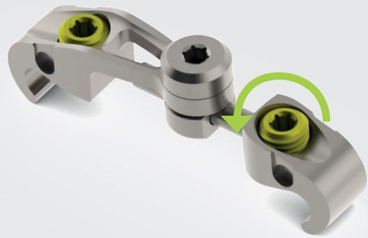
Abb. 5 Vorbereitung des Querverbinders durch Zurückdrehen der Madenschrauben.
